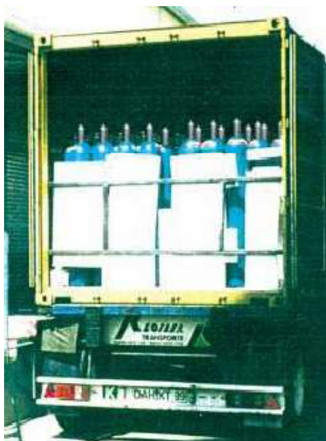
Figure 8 – Arrimage de bouteilles en position verticale dans un conteneur maritime
