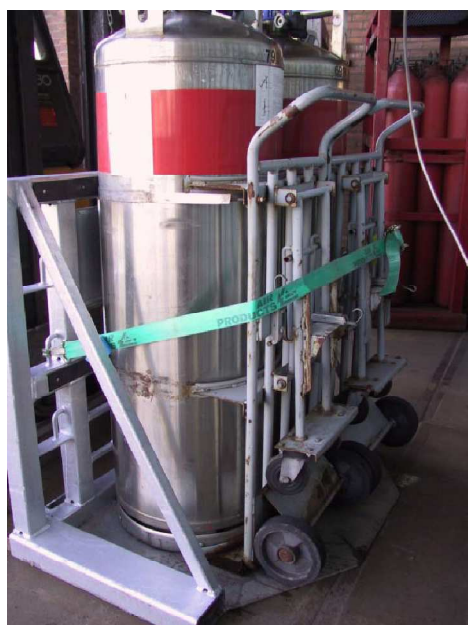
Figure 34 – Un panier standard avec berceau de bois sur la partie arrière du panier. Le berceau peut être changé pour être adapté au diamètre du récipient cryogénique.
