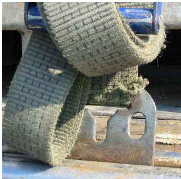
Figure 26 - Les angles aigus endommagent les sangles
