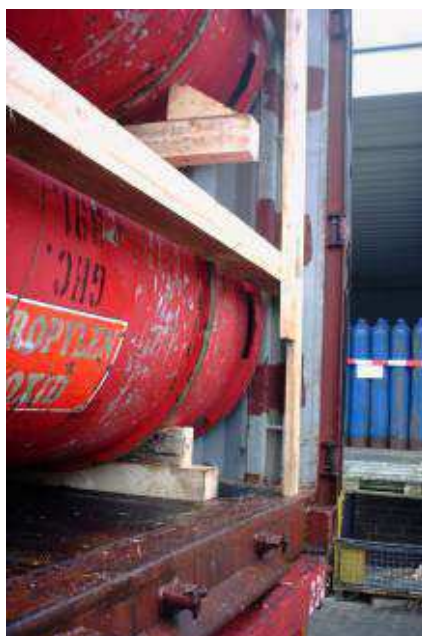
Figures 35 to 37 – Récipients à pression arrimés par des sangles ou des pièces de bois
