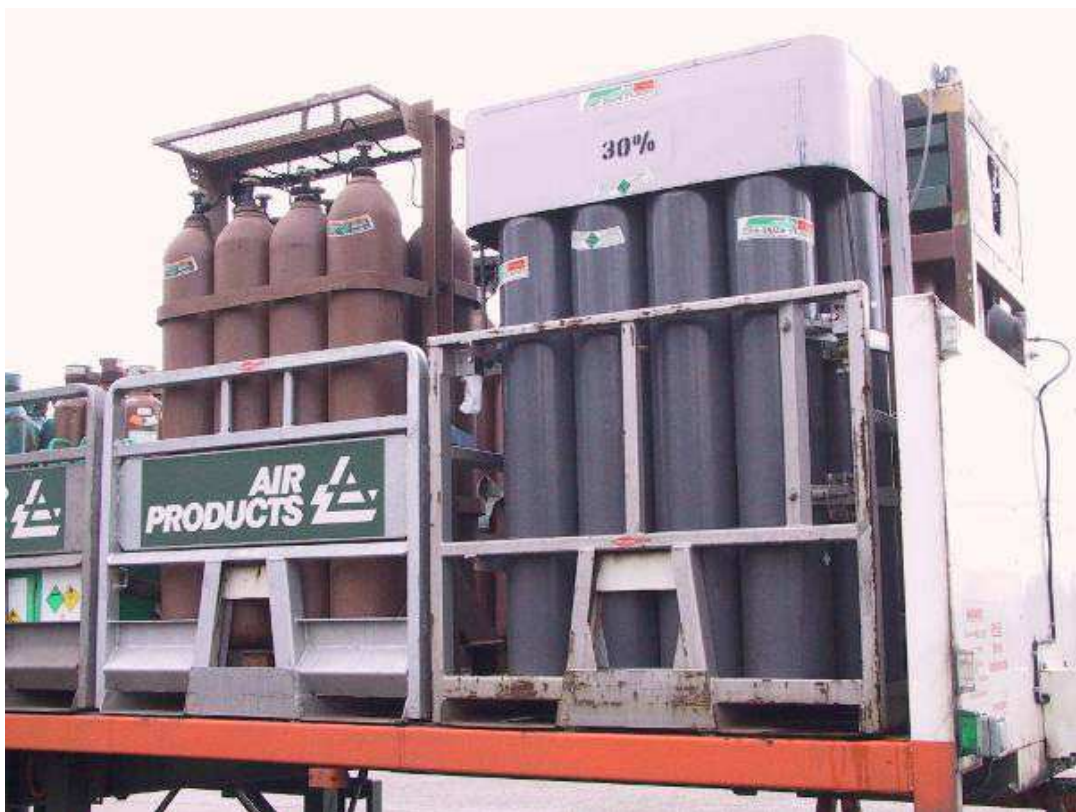
Figures 9 to 10 – Deux systèmes comportant des indexes fixés au rebord extérieur du plateau. Les paniers possèdent un fourreau qui, lorsque l'index y est engagé, maintiennent dans toutes les directions. Ce type de système élimine le besoin d'équipements complémentaires d'arrimage
