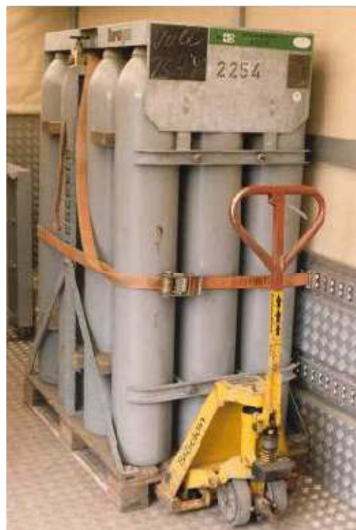
Figure 31 - Cadre de bouteilles arrimée à la paroi renforcée.
