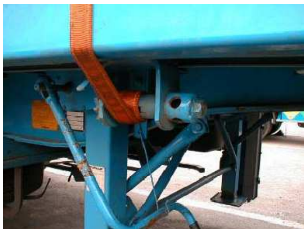
Figures 23 and 24 - Tourets de tension des sangles places sous le plateau. Des sangles placées transversalement sécurisent les charges
