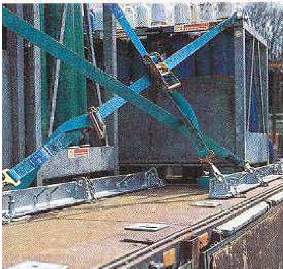
Figure 27 - Des fers plats sont fixés au plateau.
