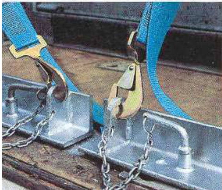
Figure 28 - Des rails d'ancrage sont fixés dessus le plateau et bloqués par des goupilles
