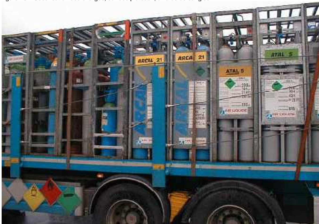
Figure 23 Sécurisation de charges à l'aide de sangles sur des plateaux standards
