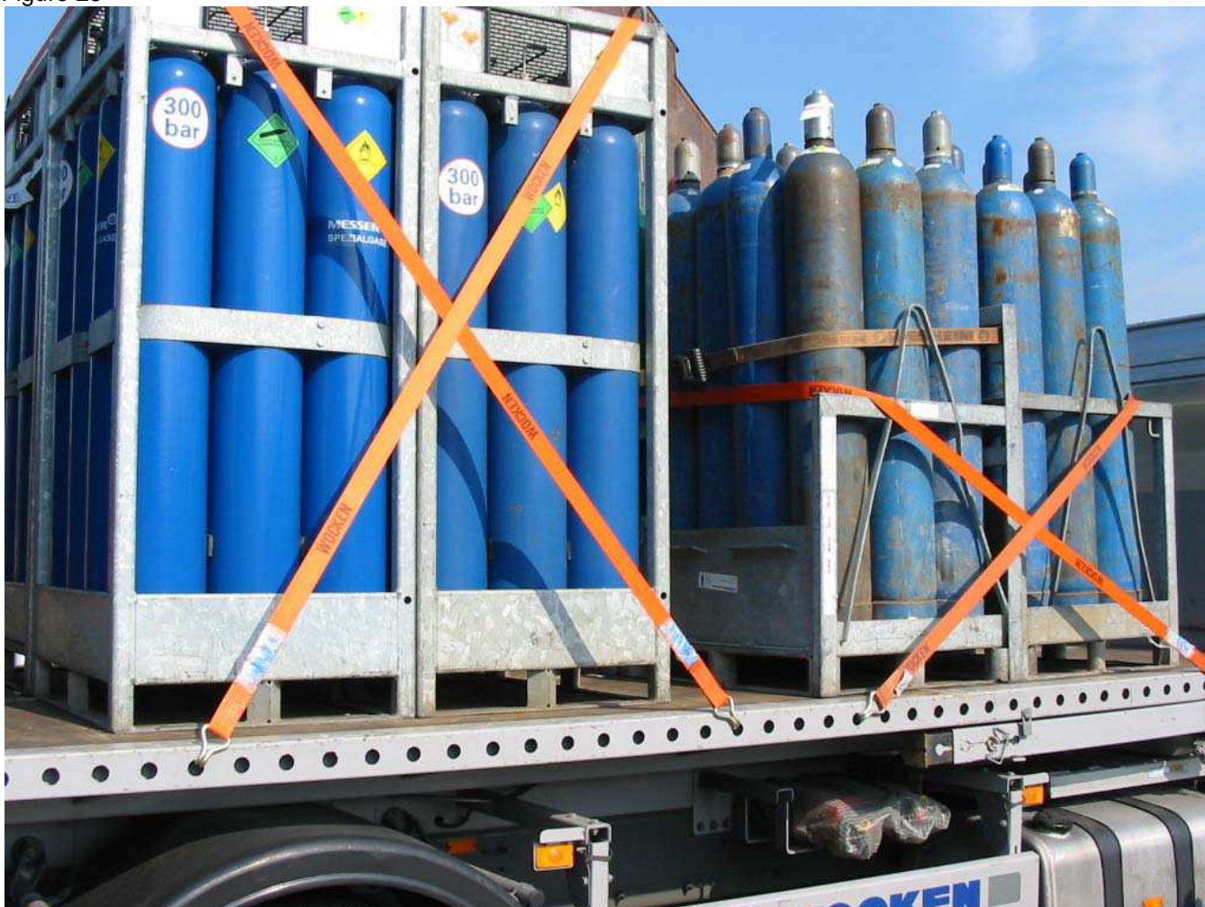
Figure 25 – Rives du plateau avec des orifices pour le passage des crochets. Cela permet un arrimage en diagonale
