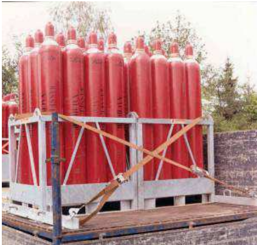
Figures 27 to 29 - Les rails servent à la fois à empêcher tout mouvement des charges et à les maintenir sur le plateau. Véhicule standard équipé de plaques de verrouillage sur le plateau et de supports pouvant être fixés
