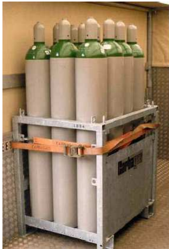
Figure 30 - Arrimage par sangle d'un panier sur une paroi renforcée. La sangle peut être protégée afin de ne pas être endommagée par les angles du panier.
